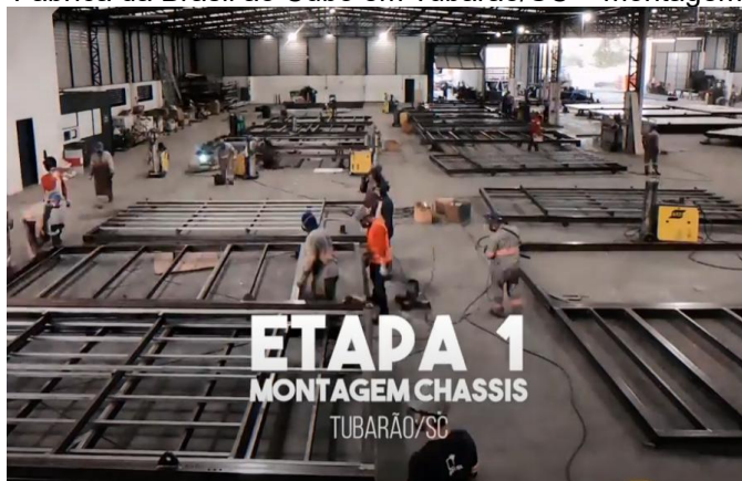
Figure 22 – Fábrica da Brasil ao Cubo em Tubarão/SC – montagem dos chassis
