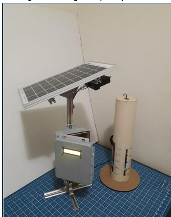
Figura 6. Montagem do protótipo ETAP.
