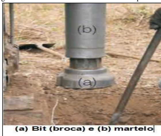
Figura 10. Materiais utilizados no método rotopneumático
